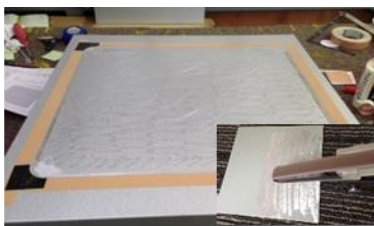
①表面をベルトサンダー等で入念に目粗し後、マスキング
