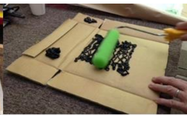
③パレットに樹脂を出し、ローラーに樹脂を馴染ませる
