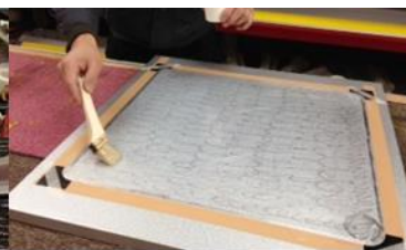
②無水エタノール等で油分除去後専用プライマー塗布
